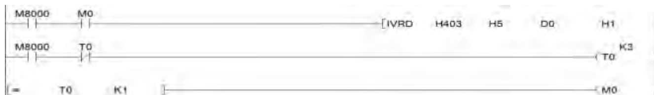
Figura 9. Lectura del sensor en PLC.
